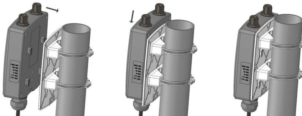
**Paso 6.** Después de montar el radio en el soporte, instale el tornillo en la parte inferior del radio para fijar completamente el radio y el soporte (ítem E de la *Figura 1 – Contenido del kit APC 2M*).
